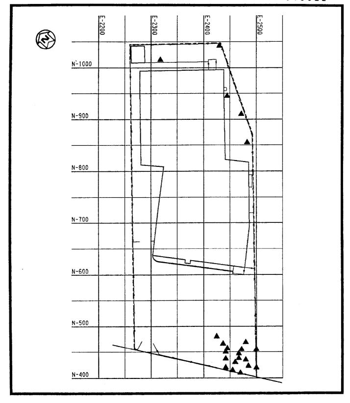
FIGURE 2 SURFACE SOIL SAMPLING LOCATIONS AT BERGEN CABLE
