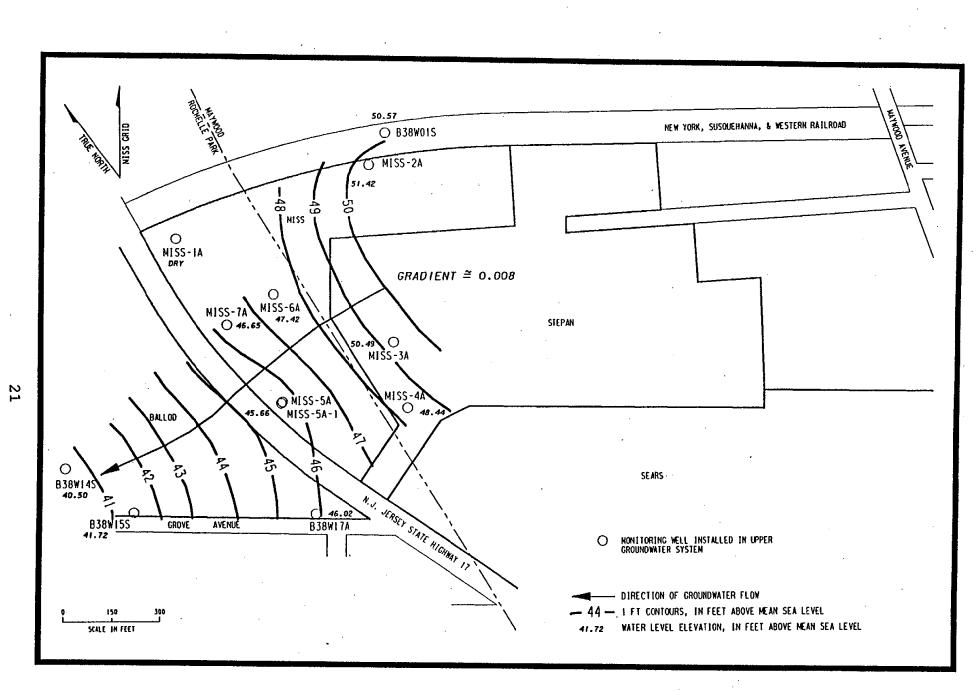
FIGURE 1-12 POTENTIOMETRIC SURFACE MAP OF THE UPPER GROUNDWATER SYSTEM AT MISS (8/1/89)
