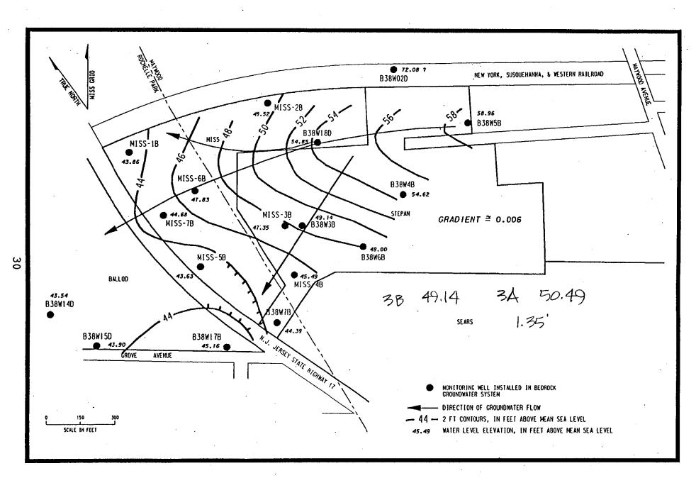
FIGURE 1-20 POTENTIOMETRIC SURFACE MAP OF THE BEDROCK GROUNDWATER SYSTEM AT MISS (8/1/89)
