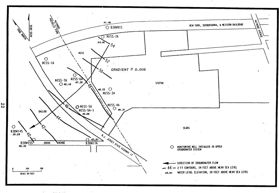
FIGURE 1-13 POTENTIOMETRIC SURFACE MAP OF THE UPPER GROUNDWATER SYSTEM AT MISS (12/6/89)
