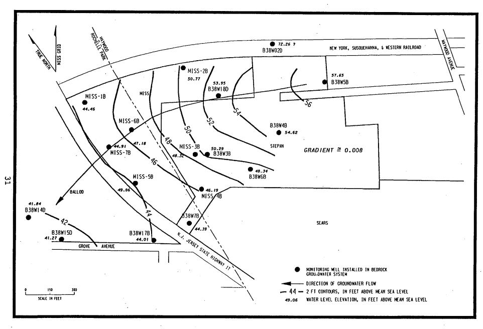
FIGURE 1-21 POTENTIOMETRIC SURFACE MAP OF THE BEDROCK GROUNDWATER SYSTEM AT MISS (12/6/89)
